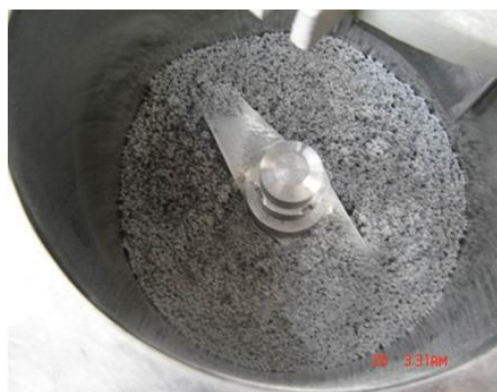
图2.1 熔融纺共混包粘法混合料
